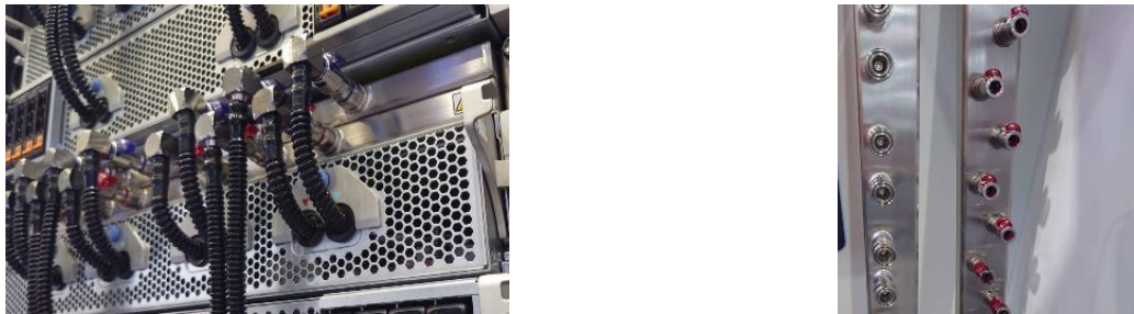
圖 4：客戶指定提供快接頭(QD；Quick Disconnect Coupling)，高力以真空爐硬銲後提供予客戶
