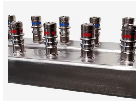
圖 10：冷卻液分歧管(CDM)，CDM 向每台伺服器供應冷卻劑並將較熱的冷卻劑收集回 CDU
