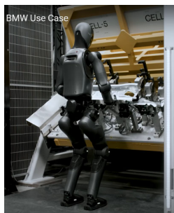
Figure 02成功執行在4分鐘內將鉸金件對準小於1公分孔洞並插入的任務。
