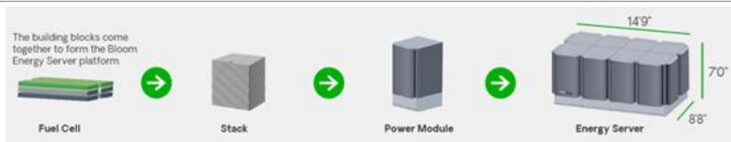
圖 10：Bloom Energy 燃料電池用於電力供應
