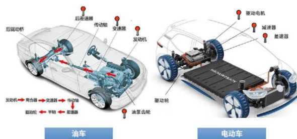
圖 35：齒輪在燃油車與新能源車示意圖
