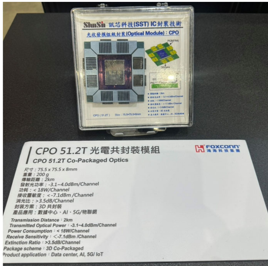
圖三、CPO 51.2T 光電共封裝模組展示圖
