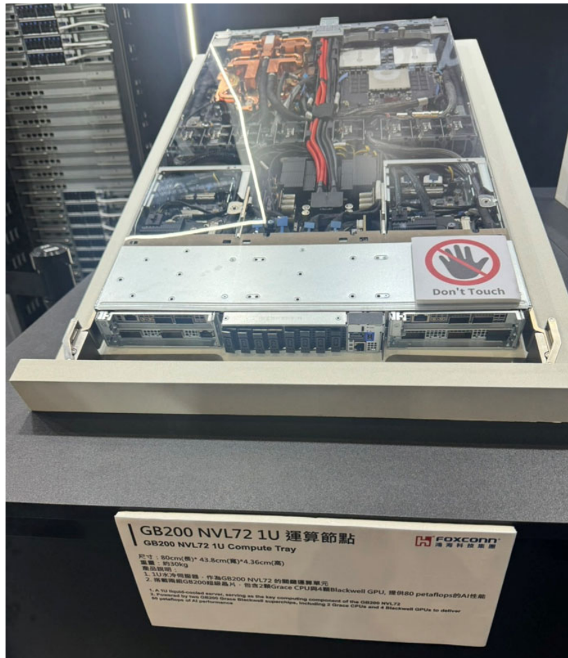
圖六、NVIDIA GB200 NVL72 1U 運算節點現場展示圖
