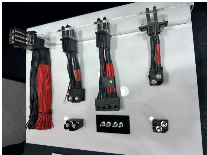
圖九：大電流連接器與線纜方案(Power Busbar Solution)
