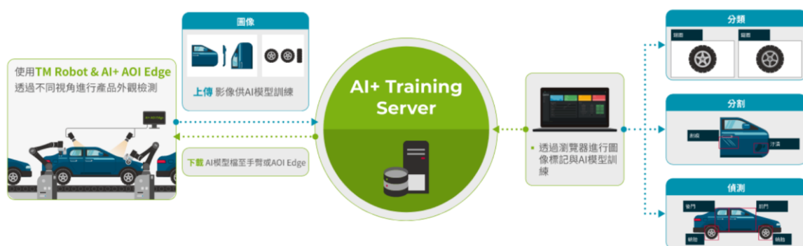
圖 10：達明 AI 視覺運作架構，從蒐集影像、圖片標籤、訓練到部署模型
