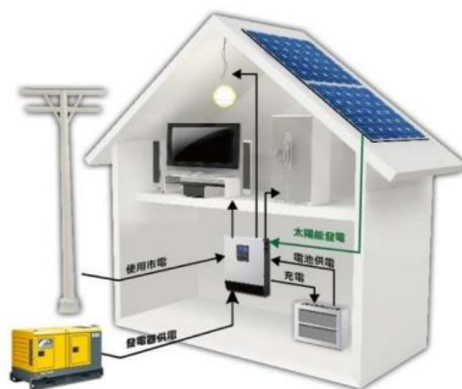
圖 18：Off-Grid Inverter 架構圖
