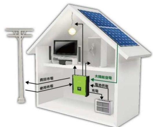
圖 19：Hybrid Inverter 架構圖
