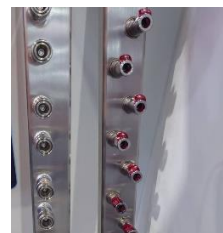
圖 4：客戶指定提供快接頭(QD；Quick Disconnect Coupling)，高力以真空爐硬銲後提供予客戶
