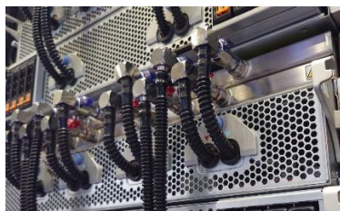
圖 4：客戶指定提供快接頭(QD；Quick Disconnect Coupling)，高力以真空爐硬銲後提供予客戶
