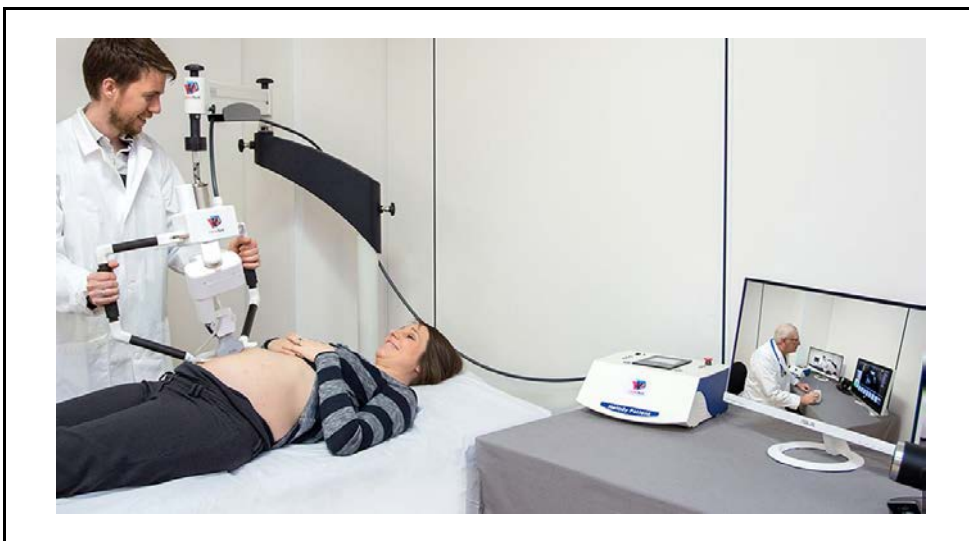
圖 3-2-1 AdEcho Tech 公司的臨床機器人遠距遙控心臟超音波系統 MELODY
