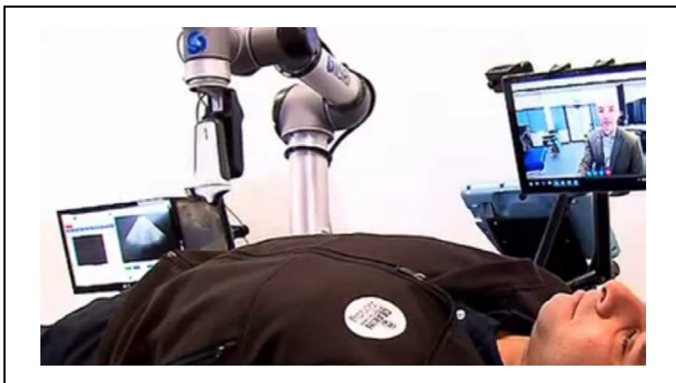
圖 3-2-5 澳洲 Deakin 大學和 Telstra 合作開發的遠距超音波掃描系統
