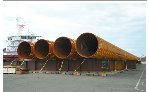
圖 13：離岸風電水下基礎
