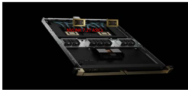
圖 8：每一層 GB200 Switch tray 皆有兩個 Nvlink 晶片
