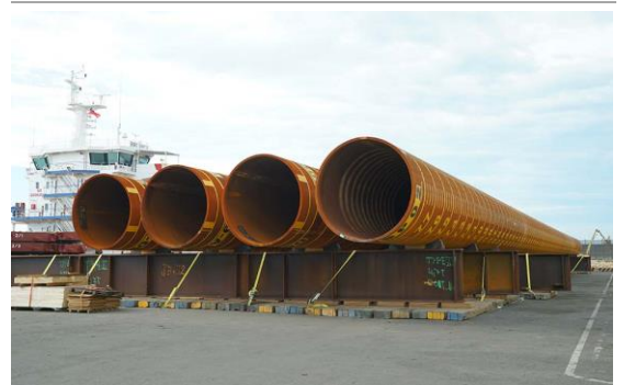
圖 13：離岸風電水下基礎
