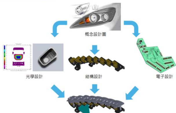
圖 35：LED 車燈模組設計流程
