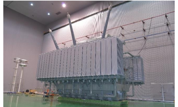
圖 5：530kV-775MVA 外銷美國昇壓變壓器
