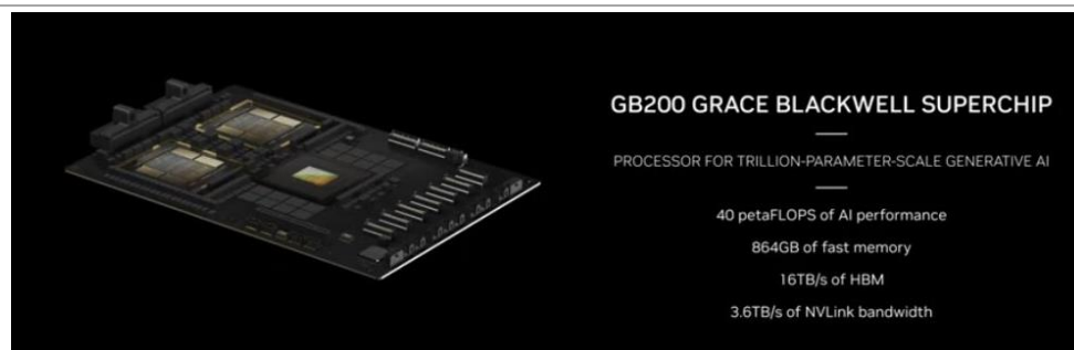
圖 27：1 個 GB200 超級晶片含有 2 個 Blackwell GPU 和 1 顆 Grace CPU
