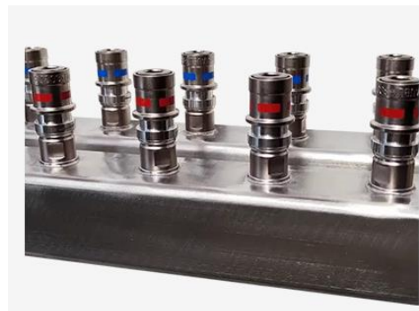
圖 12：冷卻液分歧管(CDM)，CDM 向每台伺服器供應冷卻劑並將較熱的冷卻劑收集回 CDU。
