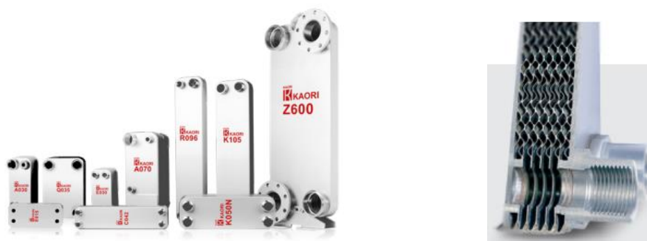
圖 5：板式熱交換器為沖壓成形之山形波紋板片組成，可在高溫高壓工作系統中提供高效率傳熱
