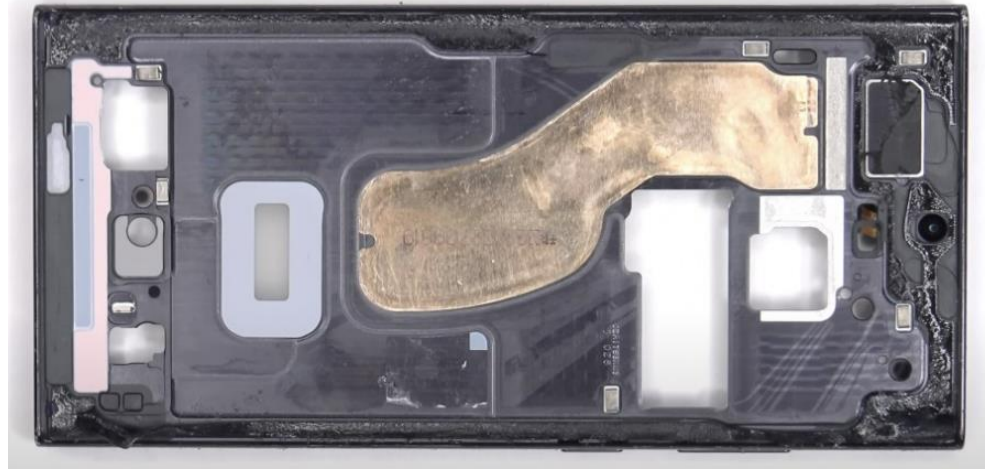
圖 3：S24 散熱模組較前一代大 1.9 倍
