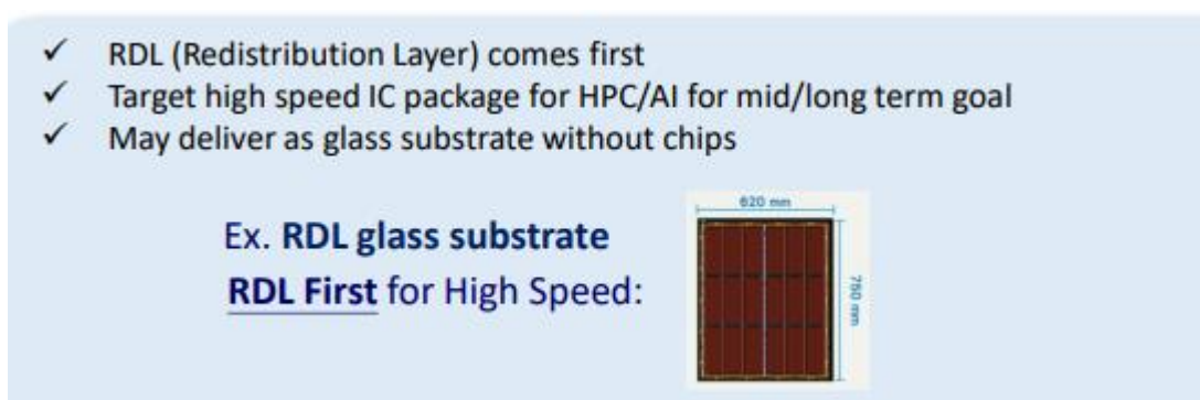
圖 3：扇出型面板級封裝(FOPLP)進度，RDL-First 適用於 HPC/AI 應用
