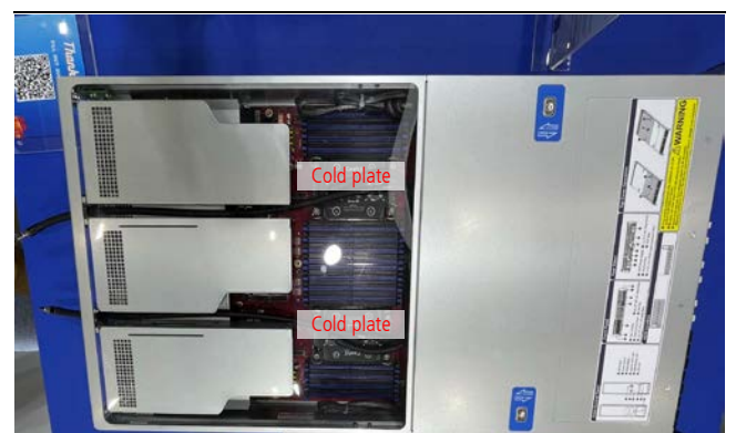
圖 6：水冷伺服器標準品 — 勤誠
