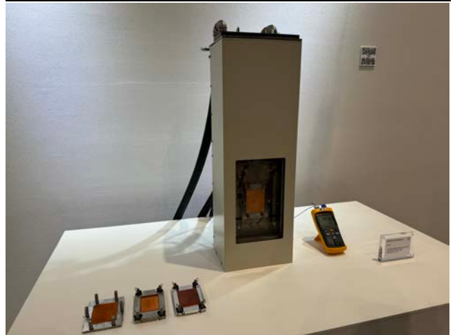
圖 28: 雙項式浸沒式水冷技術
