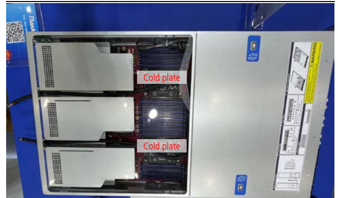
圖 8：水冷伺服器標準品 — 勤誠
