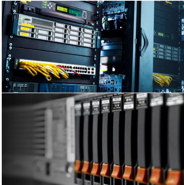
圖 4：伺服器類型比較，機架式伺服器(上)、刀鋒伺服器(下)
